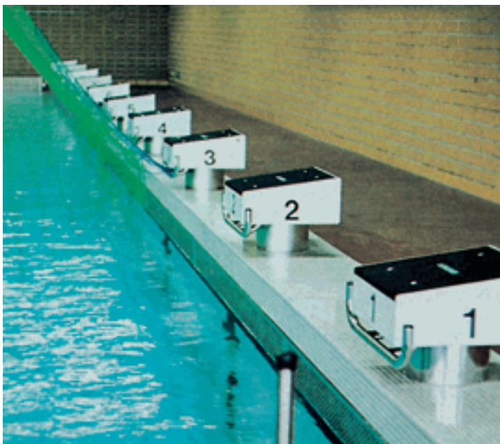
Startsockel Nr. R 1610 für Überflutungsrippen zum Einbetonieren in den Beckenkopf vor dem Überlaufkanal. Der Startsockel besteht aus einer 115 Ø Rundsäule mit aufgeschweißtem Absprungkasten 0,50 x 0,50 m, 0,13 m hoch, mit 5° zum Becken geneigt. Die Absprungfläche ist rutschfest mit Carborundumbeschichtung.
