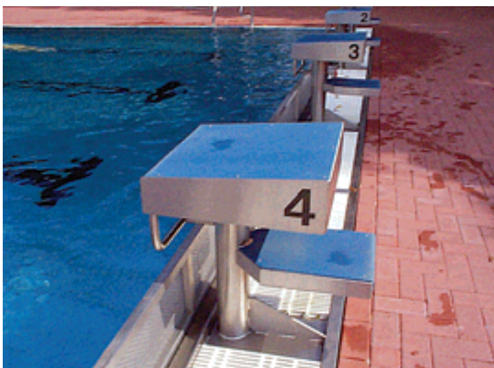
Startsockel Nr. R 1610 für Überflutungsrippen zum Einbetonieren in den Beckenkopf vor dem Überlaufkanal. Der Startsockel besteht aus einer 115 Ø Rundsäule mit aufgeschweißtem Absprungkasten 0,50 x 0,50 m, 0,13 m hoch, mit 5° zum Becken geneigt. Die Absprungfläche ist rutschfest mit Carborundumbeschichtung.
